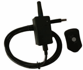
Antena para disparo por sinal de radio
