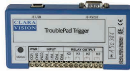
Caixa para disparo externo +/- 27v e hub USB3
